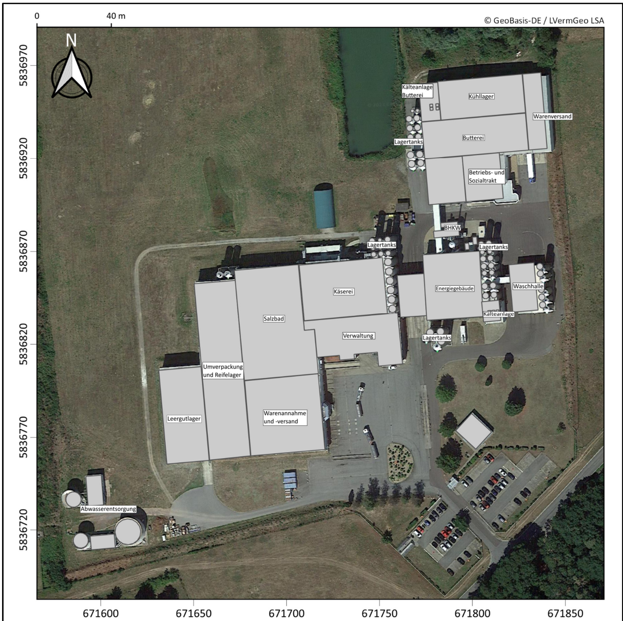
Abbildung 4: Betriebsteile/Hauptkomponenten der Altmark-Käserei Uelzena GmbH im Ist-Zustand
