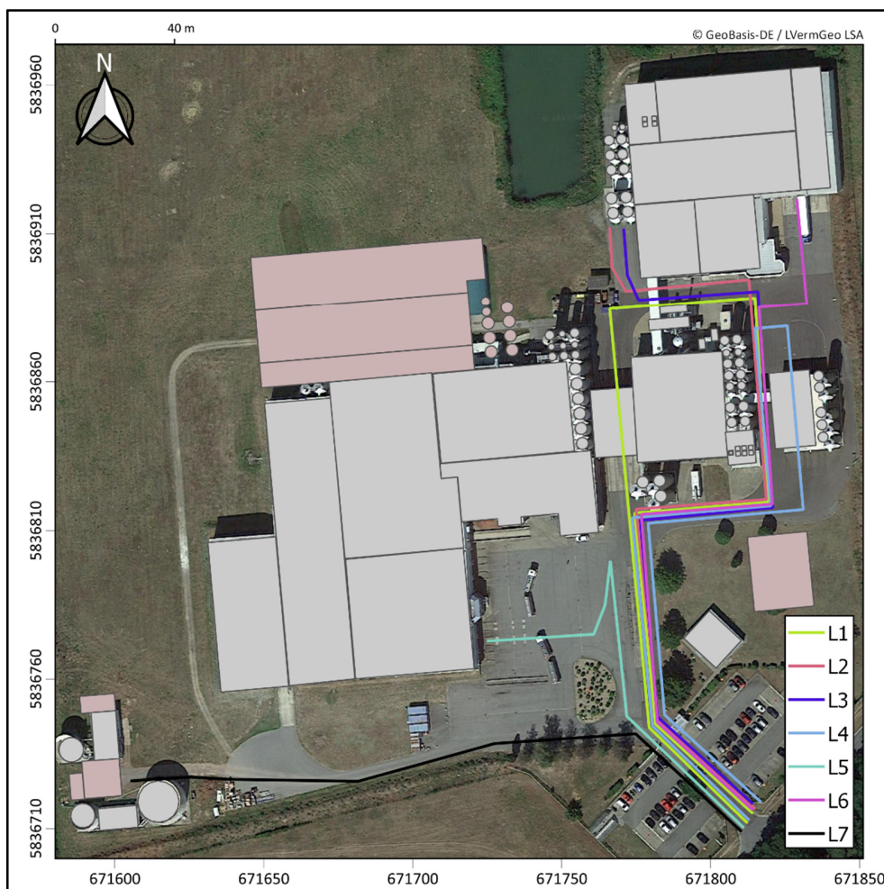
Abbildung 8: Lage der Linienschallquellen auf dem Betriebsgelände (UTM-Koordinaten)
